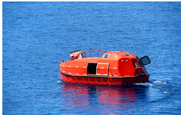
Рис. 1. Сучасна рятувальна шлюпка закритого типу на плаву
