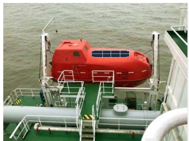
Рис. 4. Зовнішній вигляд рятувальної шлюпки дообладнаної сонячною панеллю
